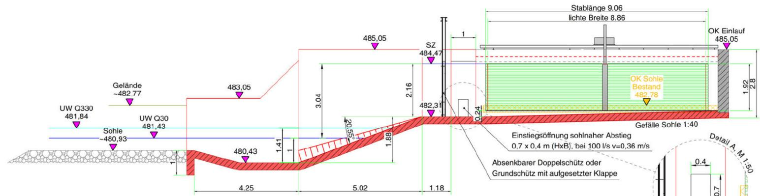
Schnitt B-B: Längsschnitt Bypasskanal - Fischabstieg
