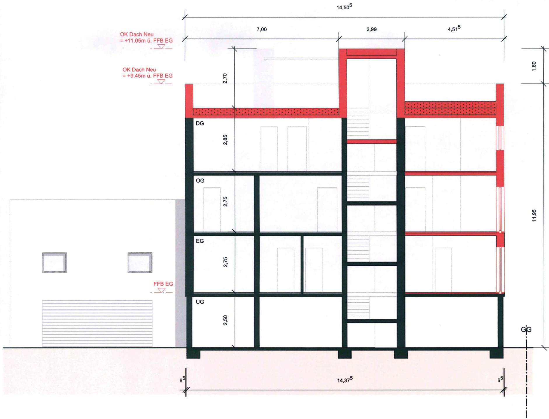
**ANBAU AN DAS BESTEHENDE WOHNGEBÄUDE. DACHFORMÄNDERUNG DES HAUPTGEBÄUDES UND DER GARAGE VON SATTELDACH AUF FLACHDACH. DACHTERRASSEN-NUTZUNG AUF FLACHDACH**
